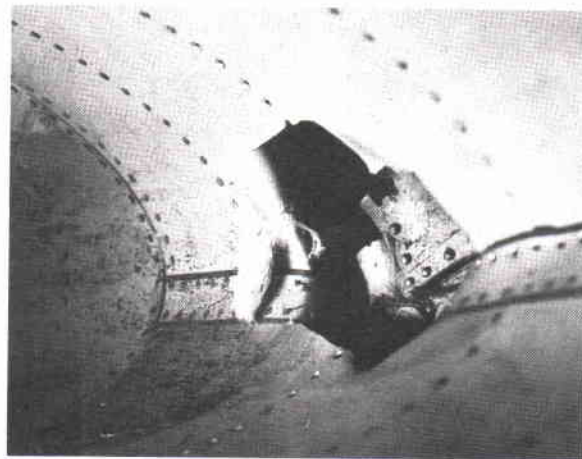
En havstrut med uppskattningsvis 2 meters spännvidd har hamnat i luftintaget på en 35:a. Förutom denna primärskada och motorskador spreds fågelrester utefter skotten, längs ryggåstrumman och ända bak i flygplanstjärten. Ett intrikat rengöringsproblem...
